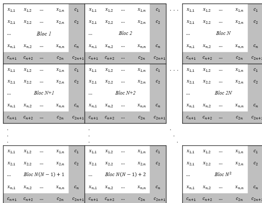
Figura 2. Distribuția pixelilor marcabili x_i și a contextului de predicție format din pixelii c_i pentru noua abordare VRAE bazată pe blocuri de pixeli
